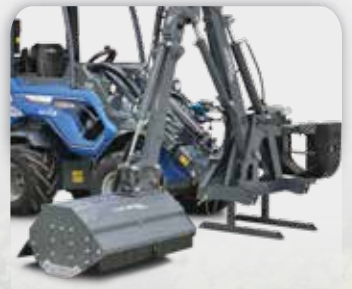
SIDE BOOM WITH FLAIL MOWER ตัดหญ้าและฟุ้งไม้ในพื้นที่ ลาดชัน ริมน้ำ ร่องน้ำ
